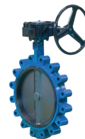
VÁLVULA BORBOLETA LUG, CORPO EM FOFO, DISCO INOX 316, EPDM, COM REDUTOR E VOLANTE
