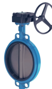
VÁLVULA BORBOLETA WAFER, CORPO EM FOFO, DISCO INOX 316, EPDM, COM REDUTOR E VOLANTE
