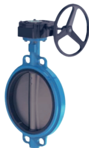
VÁLVULA BORBOLETA WAFER, CORPO EM FOFO, DISCO INOX 316, EPDM, COM REDUTOR E VOLANTE
